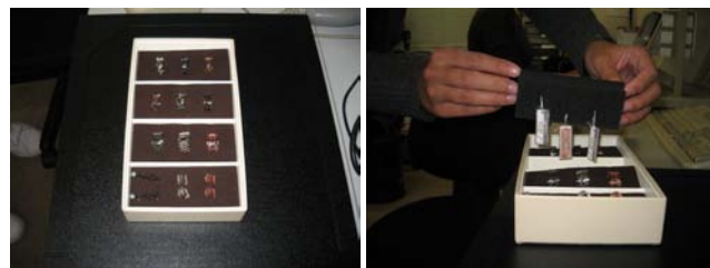
(左)丸善で使われている宝石ケースの一例、普通の状態では値札が見えずスッキリとした印象 (右)台座がスポンジ状になっており切れ込みの間からICタグ内蔵の値札を下に落としてある
